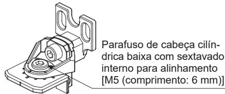
2. Como mostrado na figura abaixo, ajuste a direção deste dispositivo e a direção da superfície de instalação baixando o suporte e, em seguida, aperte e fixe o parafuso de cabeça cilíndrica baixa com sextavado interno para alinhamento. O torque de aperto deve ser de 2 N·m ou menos.
