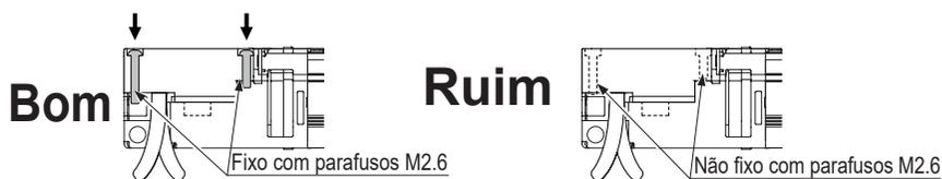
4) Não insira o conector incorretamente e aperte os parafusos M2.6.
