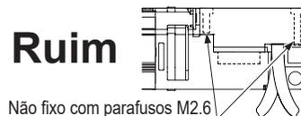
4) Não insira o conector incorretamente e aperte os parafusos M2.6.
