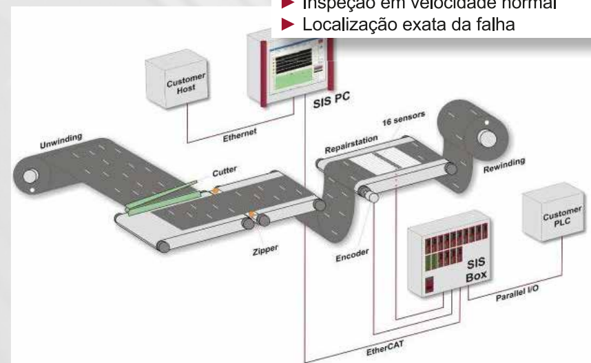
Sistema de Inspeção de corda de Aço (Fonte: ROLAND ELECTRONIC)
