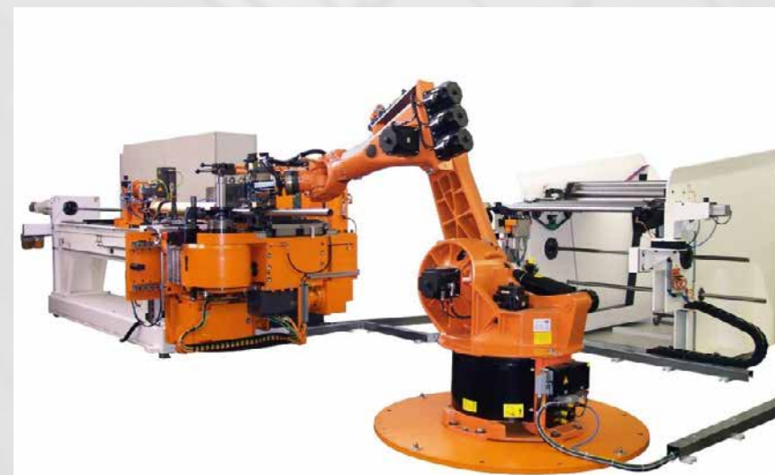
Máquina de dobramento de tubo com alimentadora automática (Fonte: Lang Tube Tec)
