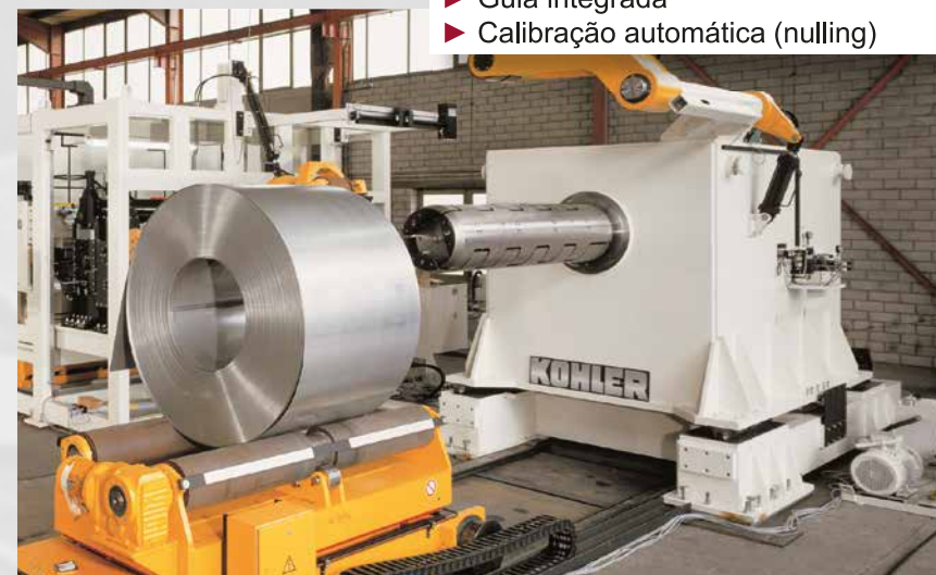
Linha de guilhotinas longitudinais (Fonte: Kohler Maschinenbau)
