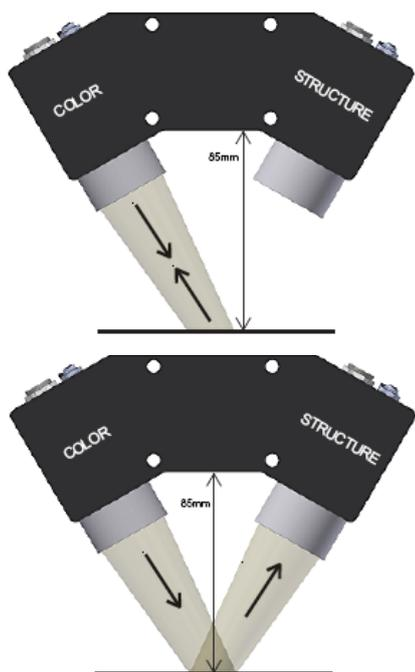
Sensores da série COAST (Color And Structure) trata-se de sensores híbridos, constituídos por dois sensores sincronizados pela iluminação de lâmpada por anéis LED, mas, regra geral, de funcionamento independente.
