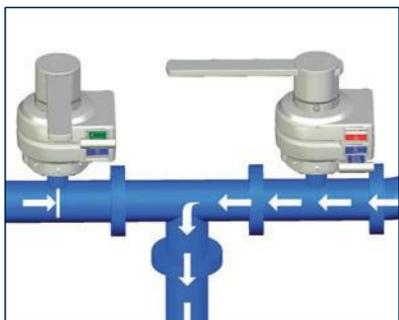
Este exemplo mostra a troca de uma mídia (tubo da direita) para outra (tubo da esquerda). Deve-se evitar qualquer mistura das duas mídias. A mídia está fluindo no tubo da direita, onde a válvula está aberta. Isso é indicado pelo eixo superior de chave A (vermelho) livre. É impossível operar a válvula; ela está travada. A chave inferior B (azul) está presa no eixo. A válvula do tubo da esquerda está fechada, portanto, nenhuma mídia pode fluir por esse tubo.
