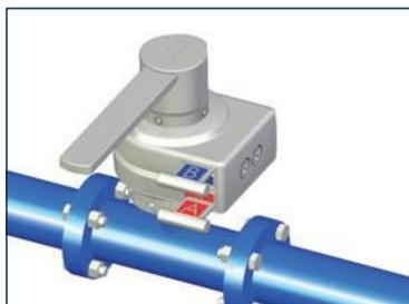
A pessoa autorizada fecha a válvula. Durante a operação, as chaves A (vermelha) e B (azul) ficam presas. Assim que a alavanca da válvula está em sua posição final, a chave A (vermelha) é liberada
