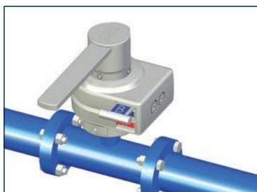
A válvula está fechada. A chave inferior A (vermelha) pode ser removida. Ao retirar a chave, a válvula é travada novamente e não pode mais ser operada. A chave superior B (azul) permanece presa no slot. O estado da válvula (fechada) é claramente visível pelo slot inferior vazio
