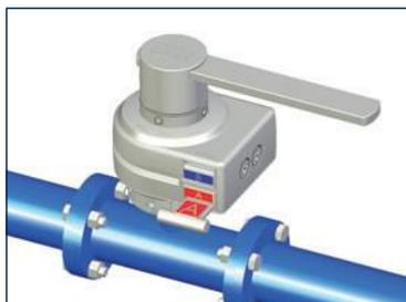
A válvula está aberta. Isso pode ser observado pelo slot superior de chave B (azul) estar vazio – tOPen. A válvula não pode ser operada; ela está travada. A chave inferior A (vermelha) está presa no slot de chave
