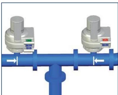
Uma pessoa autorizada insere a chave A (vermelha) no intertravamento direito. O travamento é liberado e o operador pode fechar a válvula direita. Assim que a válvula é fechada, a chave B (azul) pode ser removida. Ao retirar a chave, a válvula é travada novamente e não pode ser operada. A mídia no tubo da direita não pode mais fluir.
